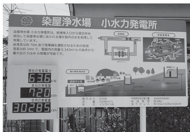
▲染屋浄水場の小水力発電電力等
